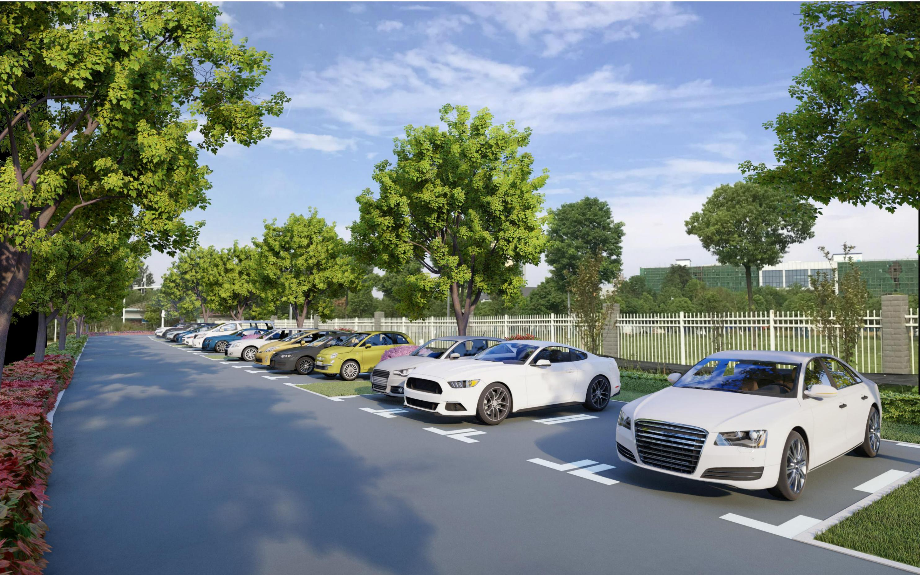
大门东侧为大客车车停车场，设计道路宽**6米**，设置有**3个4X12米**的大型停车位。除了与市政部分人行道路的隔离，还针对大型车里的行驶条件设计了**9X16米**的回车场地，优化了行驶路线上弯道半径。景观上保持了设计的一致性，以香樟、石楠球和红檵木球营造简洁大气的景观空间。
