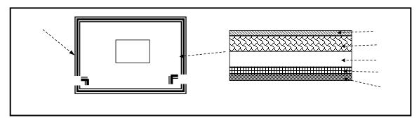
图 7-2-4 空压机房整体隔声罩及玻璃棉构造图
