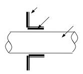
图 7-2-5 隔声罩与管道相接的方法
