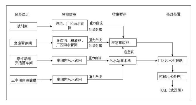
图 6-4-1 现有厂区风险事故废水收集系统示意图
