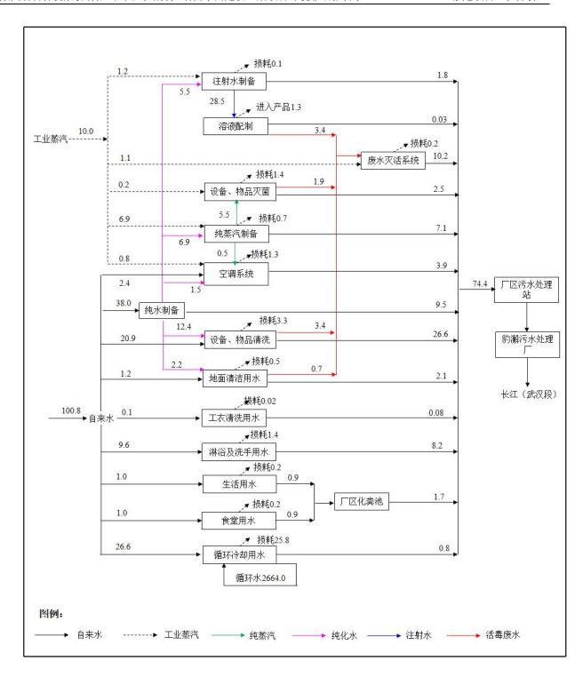
图 3-9-2 拟建项目日均给排水平衡图 (m³/d)
