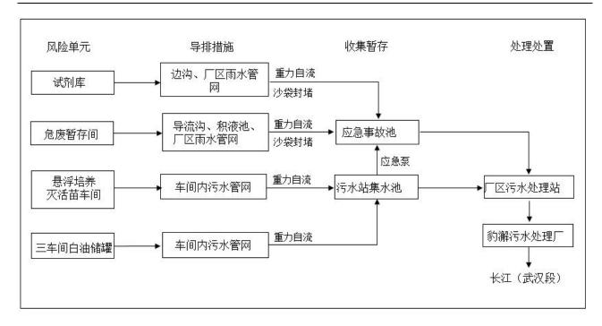
图 6-4-2 事故废水收集系统示意图
