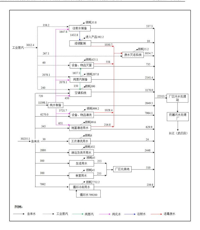
图 3-9-1 拟建项目年给排水平衡图 (m³/a)
