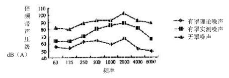
图 7-2-6 国内某空压机治理前后各频程声压级比较
