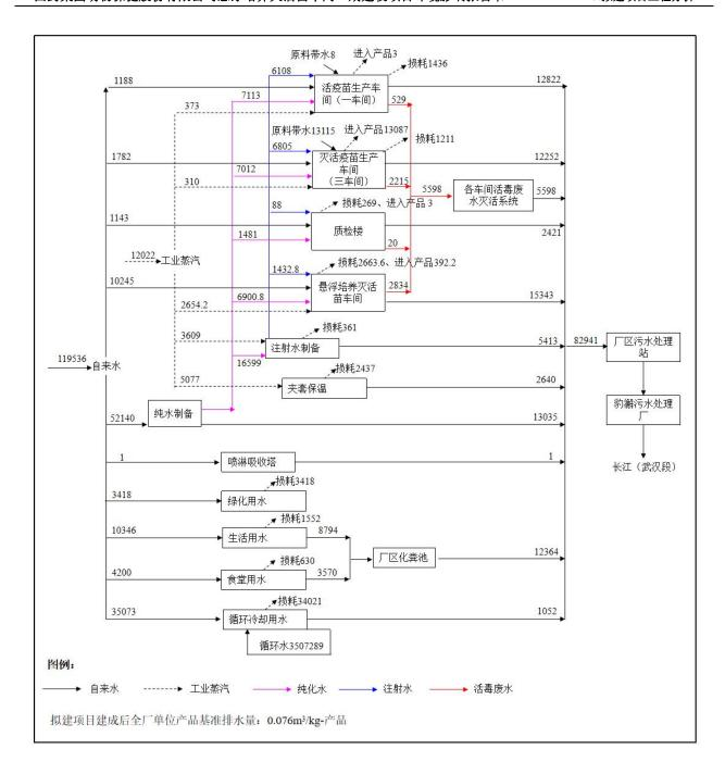
图 3-9-3 拟建项目建成后全厂给排水平衡图
