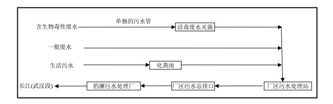
图 3-10-1 拟建项目废水分质处理示意图
