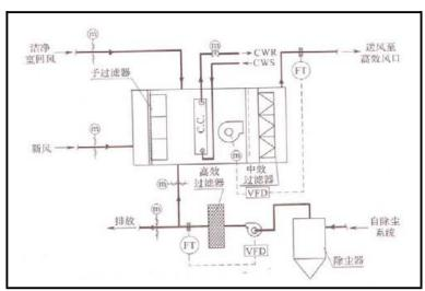
图 3-6-4 空气净化系统示意图
