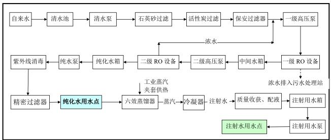
图 3-6-2 本项目纯化水、注射用水系统工艺流程图
