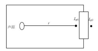
图 5-4-1 室内声源等效为室外声源图例
