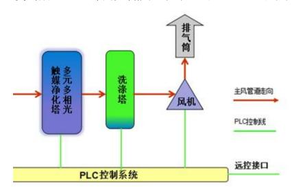
图 7-2-1 恶臭废气处理工艺流程图
