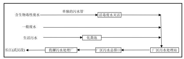
图 7-2-2 拟建项目废水分质处理管线走向示意图
