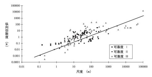
图 5-6-5 松散沉积物的弥散度确定
