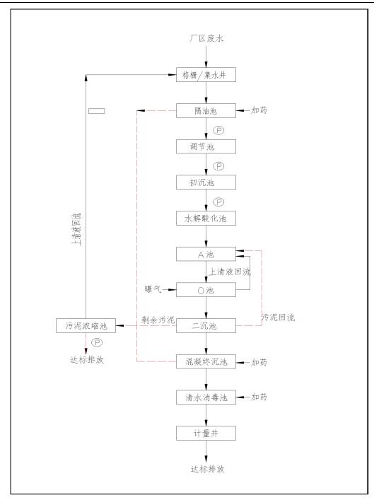
图 7-2-3 厂区污水处理站工艺流程图
